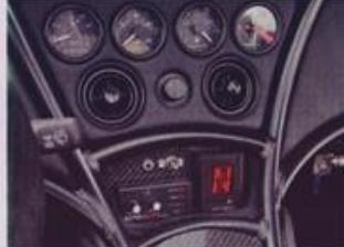
Секвентальную трансмиссию устанавливала фирма Westermann Motorsport, в салоне появился индикатор включенной передачи, блок настройки «блиппер» (перегазовки при переключениях) и пневмоаппаратура в ногах переднего пассажира
