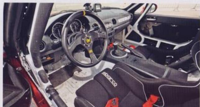
Самые дорогие элементы в программе доработки кузова и салона — каркас (110 тысяч рублей), два кресла с ремнями (119500) и композитная крыша (83600)
