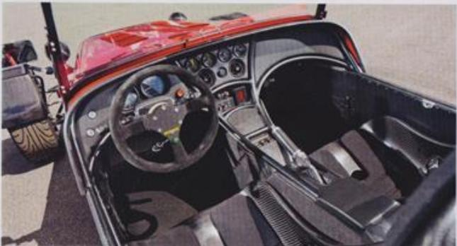
Вроде бы почти обычный салон, но для жизни вне трека здесь только печка, поворотники, ручник и сеточки для документов возле коленей. Посадка в кресло – из стойки на «брюсьях» каркаса. Зеленая кнопка на съемном руле – предохранитель включения первой передачи
