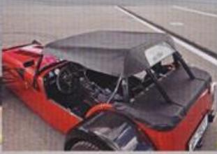
Брезентовую полукрышу можно дополнить дверьми из того же материала
