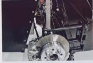
Задний мост КБ 527 разработало самостоятельно – чтобы меньше зависеть от качества жигулевских запчастей. За геометрию подвески отвечают новые продольные рычаги и тяга Панара
