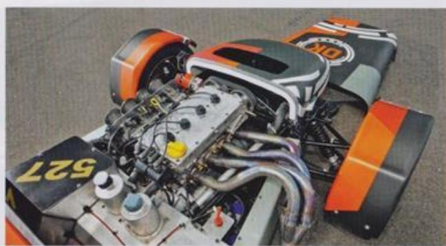
Рельефная клапанная крышка, индивидуальные дроссели, прямоток – красный мотор. Мощность 184 л.с. достигается на бензине АИ-98, а на 102-м – уже 194 силы
